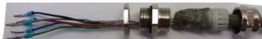
**PASSE APENAS OS CONDUTORES DO CABO, VIRANDO A MALHA NO AVESSO, SOBRE A JUNTA LAMELAR.**
