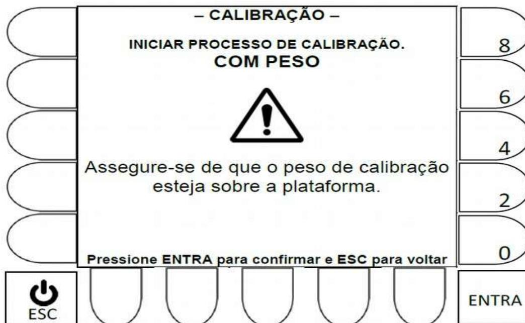
Tecla ENTRAR: Efetua a calibração Com Peso (calibração de zero).
