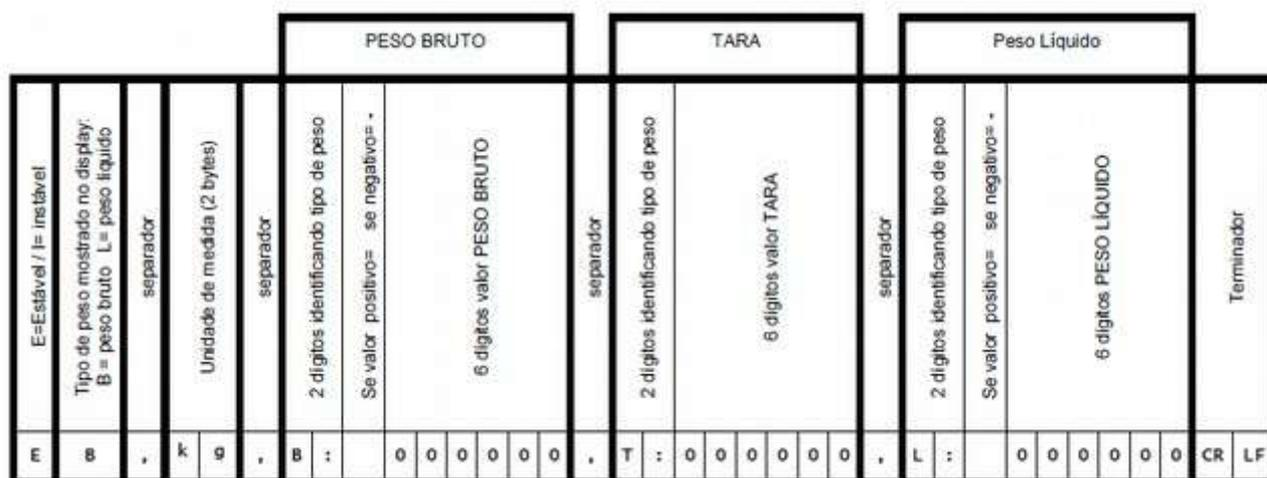
A transmissão sucessiva de medidas é iniciada assim que uma conexão for estabelecida, sendo que o dispositivo encerra a comunicação após cerca de 10 segundos automaticamente, se nenhum comando for trocado com o dispositivo neste período (sempre que um comando é trocado ou um dado é enviado para o dispositivo, o tempo de envio é estendido por cerca de mais 10 segundos, a contar do momento em que o comando foi recebido pela OP-ETH).
